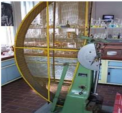
Mais la **résilience** physique, cette propriété qui **permet à un matériau à résister aux chocs**. Cette résilience se mesure en cassant une éprouvette avec un appareil d'essai approprié le mouton pendule de Charpy. De fait on mesure l'énergie qu'il faut pour casser une éprouvette normalisée et plus l'énergie est élevée plus le métal est réputé « résilient ».
