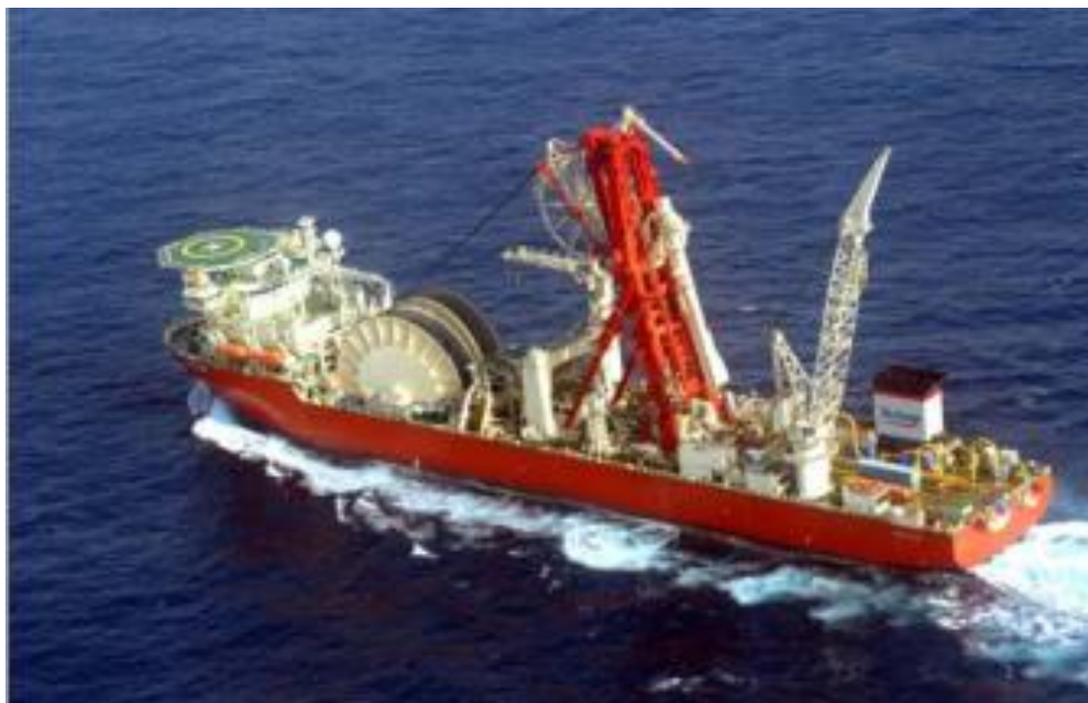
Photo 18-Le « Deep Blue, navire permettant la pose en « J » à 2500 m.
